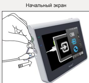
После включения aView™ кнопка ВКЛ./ВЫКЛ. загорится зеленым светом. В процессе зарядки кнопка ВКЛ./ВЫКЛ. будет светиться оранжевым светом.
